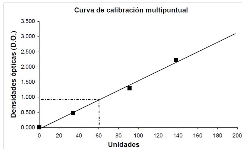
Usando la curva de calibración suministrada, la D.O. de una muestra de 0,860 a 450 nm correspondería a un valor calculado de 60 unidades. La curva de calibración suministrada es solamente un ejemplo y no debe usarse para calcular los resultados del paciente. Debe realizarse una nueva curva de calibración con cada proceso de prueba.
